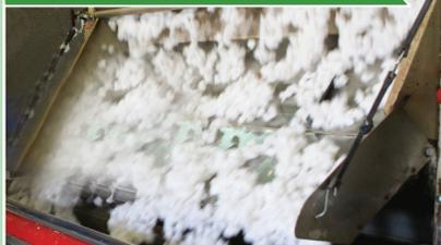
Los módulos son llevados a la desmotadora de algodón donde el algodón será secado, limpiado y separado mecánicamente de su semilla y fibra. La desmotadora contiene sierras circulares giratorias que tiran de la fibra cruda a través de nervaduras muy espaciadas que impiden el paso de la semilla.
